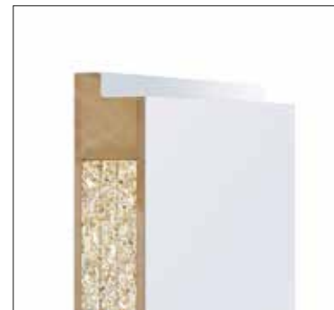
Schallschutzklasse 2 Türdicke ca. 43 mm | mehrlagige Vollspaneinlage | SK2, RwP = 37 dB
