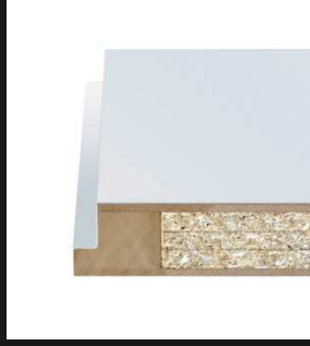
Schallschutzklasse 2 Türdicke ca. 43 mm | mehrlagige Vollspaneinlage | SK2, Rwp = 37 dB
