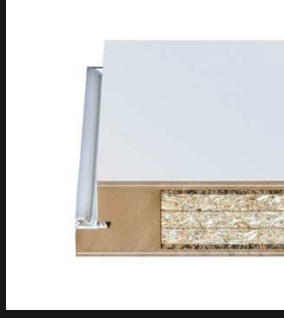
Schallschutzklasse 3 Türdicke ca. 48 mm | spezielle Schalldämmeinlage | dreiseitige Türfalzdichtung SK3, Rwp = 42 dB
