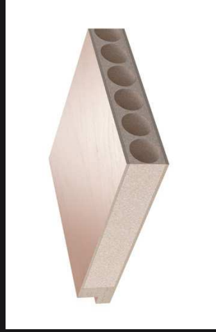
Röhrenspankern ca. 16 kg/m 3 | Prüfklima A Beanspruchungsgruppe M/Klasse 2
